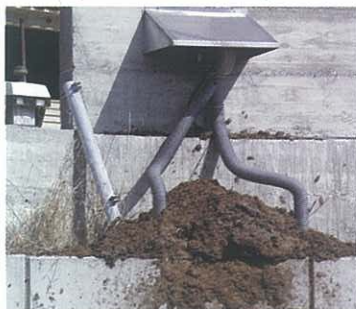
Injectie de aer pentru accelerarea compostării
